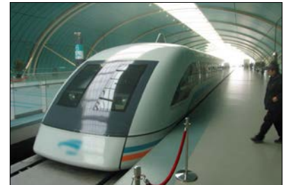
Train Maglev de Shanghai, qui exploite la sustentation magnétique pour atteindre des vitesses allant jusqu'à 500 km/h.
